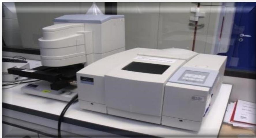
**Figure 9.** Spectromètre infrarouge type Palmer
